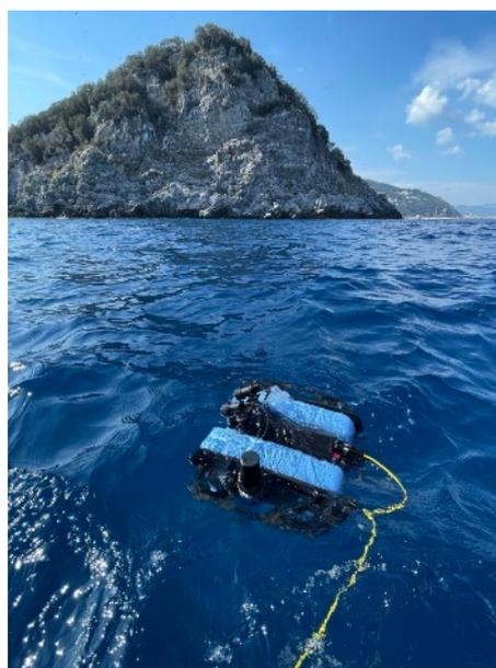
Fig. 2 - ROV modello BlueROV3 Vers. SORS con USBL e consolle di comando e ROV operativo nella parte lato mare dell'isola di Bergeggi.
