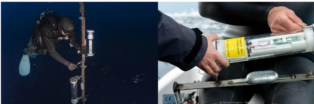
Figura 10: posizionamento dell'idrofono a largo dell'area marina protetta di Bergeggi
